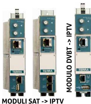
**TRSTI441C:** modulo con ingresso per 4 mux digitali terrestri DVB-T/T2, Uscita IPTV 200Mbps, e ingresso USB aggiuntivo per filmati TS da chiavetta USB
